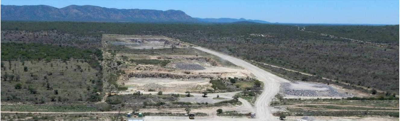
Abbau von Kalkstein, Schiefer und Mergel neben dem Zementwerk Ohorongo
